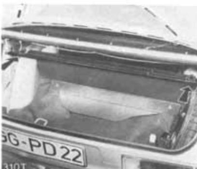
Hardtop bis zum Anschlag nach vorn schieben und in die hinteren Auflageböcke ablegen (Kreis im Bild 311 T). Durch das Schliessen des Kofferraumdeckels wird das Hardtop fixiert.
